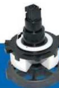
润新阀的结构，采用固定密封面的旋转实现通道开合以及流向改变。信号采集设置在一个圆面上，轻松实现自动控制，且五个工位不会重复。
